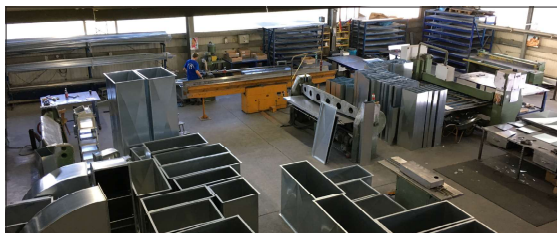
Fertigung von Luftkanälen in der Werkstatt
